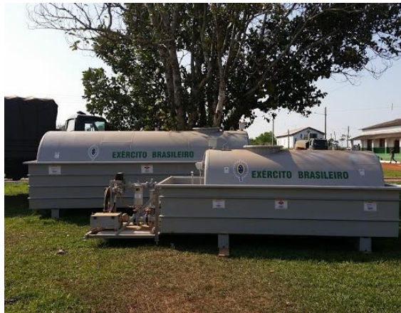
Figura 8 – Módulos de abastecimento de 5.000 e 15.000 litros.
